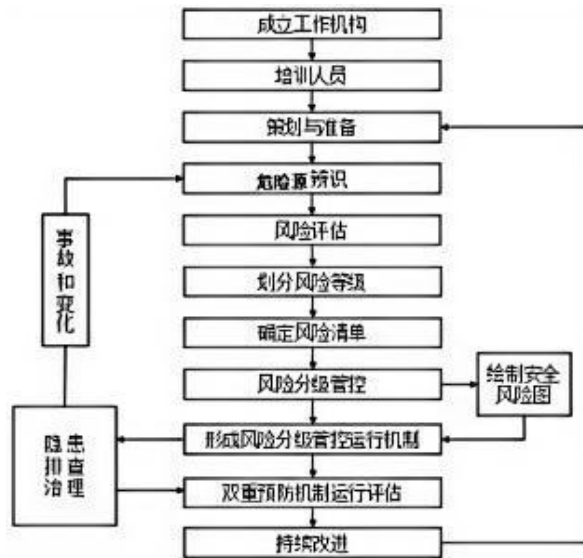
图注：双重预防机制建设（安全风险管理）工作流程
